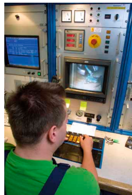
Unsere Mitarbeiter lassen einen Kanalroboter in einen Schacht ab (Bilder außen). Dieser ist mit einer Videokamera und mit Werkzeugen ausgestattet, um Schäden zu lokalisieren und zu beheben. Aus einem Auto wird der Roboter ferngesteuert (Bild Mitte).
