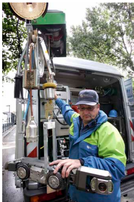
Unsere Mitarbeiter lassen einen Kanalroboter in einen Schacht ab (Bilder außen). Dieser ist mit einer Videokamera und mit Werkzeugen ausgestattet, um Schäden zu lokalisieren und zu beheben. Aus einem Auto wird der Roboter ferngesteuert (Bild Mitte).
