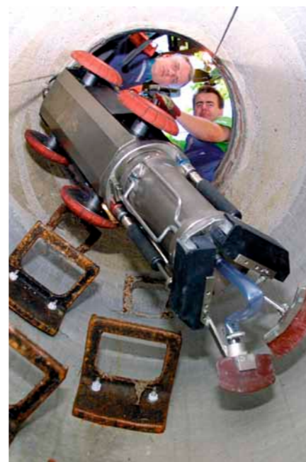
Unsere Mitarbeiter lassen einen Kanalroboter in einen Schacht ab (Bilder außen). Dieser ist mit einer Videokamera und mit Werkzeugen ausgestattet, um Schäden zu lokalisieren und zu beheben. Aus einem Auto wird der Roboter ferngesteuert (Bild Mitte).
